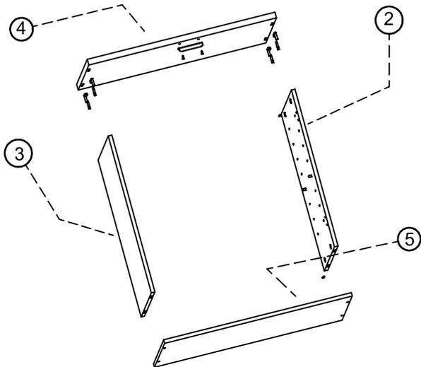
INICIE FIXANDO LATERAL DIREITA (2) , LATERAL ESQUERDA (3), TAMPO (4) , BASE E RODAPÉ (5).
