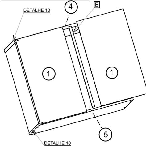
PARA FACILITAR O ESQUADRO NA MONTAGEM DO FUNDO (1) COM O MÓVEL DEITADO, POSICIONE UMA DAS CHAPAS, CERTIFIQUE-SE QUE O MÓVEL ESTEJA NO ESQUADRO E FIXE A CHAPA COM DOIS PREGOS (N) NO TAMPO(4) E NA BASE(5) , ENTÃO ENCAIXE O PERFIL (E) E POSICIONE A OUTRA CHAPA, CERTIFIQUE-SE QUE O MÓVEL ESTEJA NO ESQUADRO E FAÇA A FIXAÇÃO TOTAL DO FUNDO (1).
