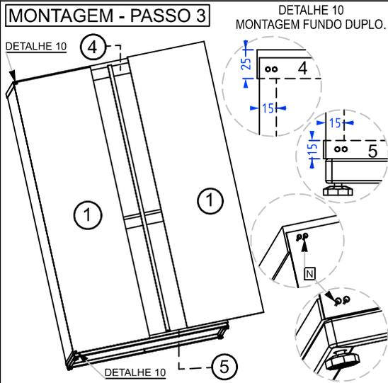
PARA FACILITAR A MONTAGEM DO FUNDO (1) COM O MÓVEL DEITADO, POSICIONE UMA DAS CHAPAS, CERTIFIQUE-SE QUE O MÓVEL ESTEJA NO ESQUADRO E FIXE A CHAPA COM DOIS PREGOS (N) NO TAMPO(4) E NA BASE(5) CONFORME DETALHE, ENTÃO ENCAIXE O PERFIL H (10) E POSICIONE A OUTRA CHAPA, CERTIFIQUE-SE QUE O MÓVEL ESTEJA NO ESQUADRO E FAÇA A FIXAÇÃO TOTAL DO FUNDO (1).
