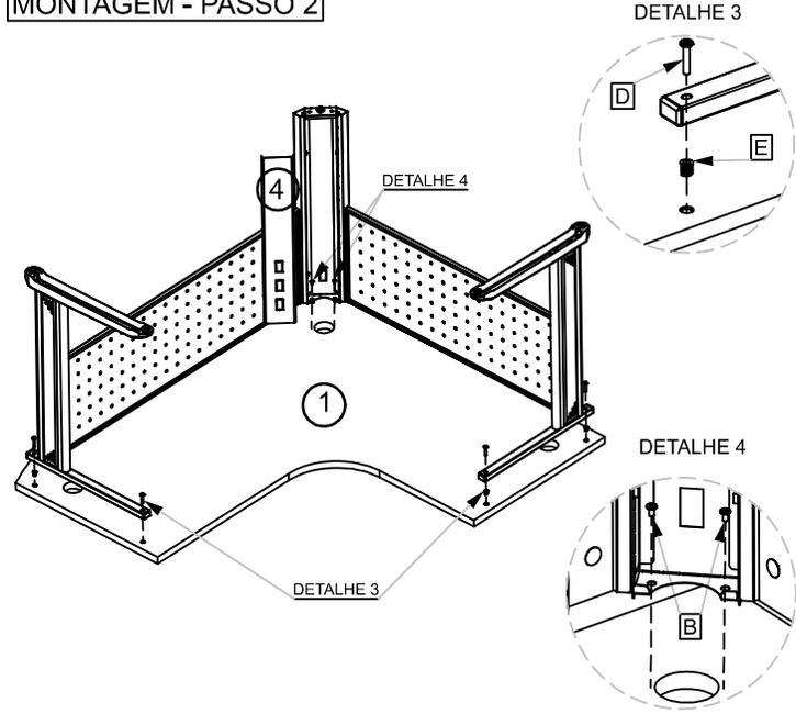
NA SEQUENCIA PARA FACILITAR A FIXAÇÃO DO TAMPO (1) NA ESTRUTURA, POSICIONE O TAMPO (1) NO CHÃO E FAÇA A FIXAÇÃO TOTAL DOS PÉS LATERAIS COM OS PARAFUSOS(D), EM SEGUIDA DESTAQUE O FRONTAL DO PÉ CARAMBOLA(4) PARA FIXAR OS PARAFUSOS (E) AO TAMPO (1).
