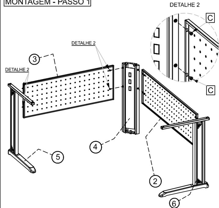
INICIE MONTANDO A ESTRUTURA: FIXE O PÉ LATERAL ESQUERDO (5), E O PAINEL FRONTAL ESQUERDO (3) E O PÉ CARAMBOLA COM OS PARAFUSOS (C), EM SEGUIDA FIXE O PÉ CARAMBOLA (4), PAINEL FRONTAL DIREITO (2) E O PÉ LATERAL DIREITO (6) CONFORME DETALHE 2.
