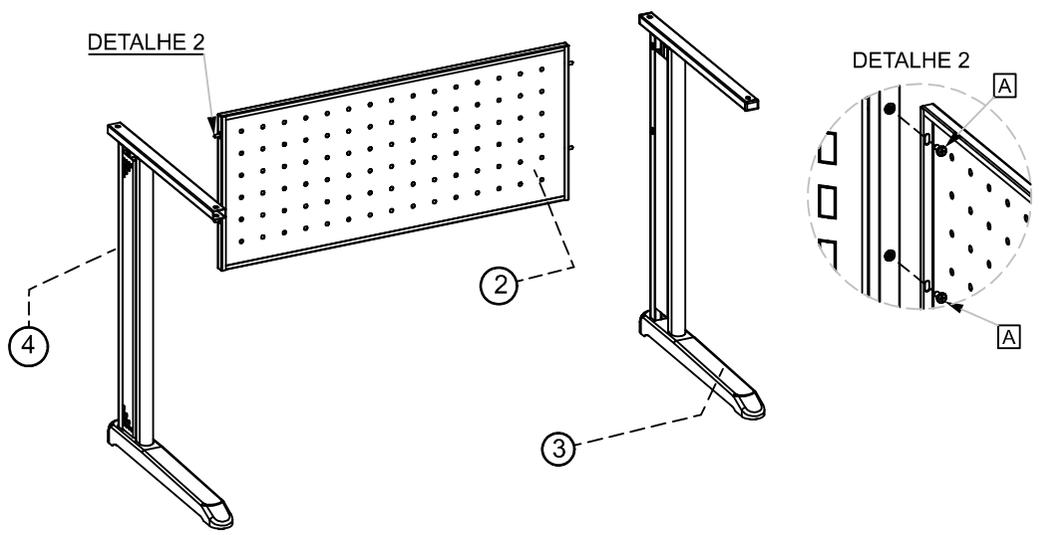
INICIE MONTANDO A ESTRUTURA: FIXE O PÉ LATERAL DIREITO (3), PAINEL FRONTAL (2) E PÉ LATERAL ESQUERDO (4) COM OS PARAFUSOS (A) COMO INDICA O DETALHE 2.
