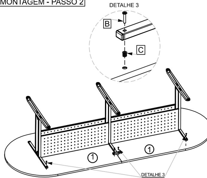
NA SEQUENCIA PARA FACILITAR A FIXAÇÃO DO TAMPO (1) NA ESTRUTURA, POSICIONE O TAMPO (1) NO CHÃO E FAÇA A FIXAÇÃO TOTAL DOS PÉS LATERAIS COM OS PARAFUSOS (B).
