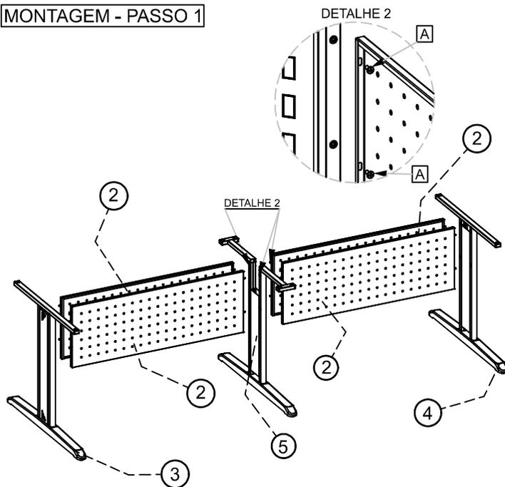
INICIE MONTANDO A ESTRUTURA: FIXE O PÉ LATERAL ESQUERDO (3), O PAINEL CENTRAL (2) E O PÉ CENTRAL (5) COM OS PARAFUSOS (A) EM SEGUIDA FIXE O PAINEL CENTRAL (2) E O PÉ LATERAL DIREITO (4) CONFORME O DETALHE 2.
