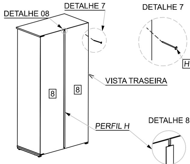
Após a fixação Laterais, fixar o Fundo (8) com a utilização de Pregos e Perfil H (Detalhe 08).
