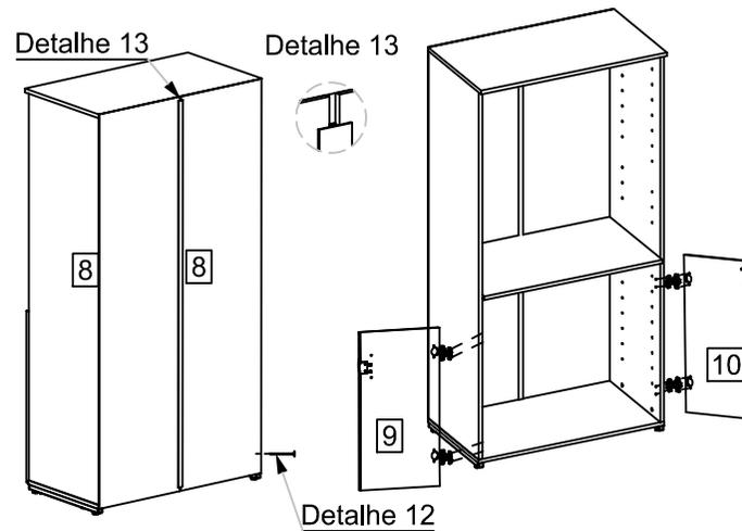
Na sequência fixar o Fundo (8) com a utilização de pregos (H) nas Laterais (1) e (3) e Prateleira Fixa (2). Após a fixação do Fundo, fazer a colocação das Portas, peças (09) e (10), utilizando o parafuso item (L), conforme (Detalhe 08). Obs: As portas devem ser ajustadas após a instalação.
