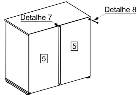
Na sequência fixar o Fundo (5) com a utilização de pregos (H) nas Laterais (1) e (3), Tampo (2) Base (4) e perfil H, conforme (Detalhe 7 e 8).
