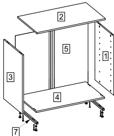
Inicie fixando a Lateral Direita (1) à Base (4), Lateral Esquerda (3) Tampo (2) e Rodapé (7).
