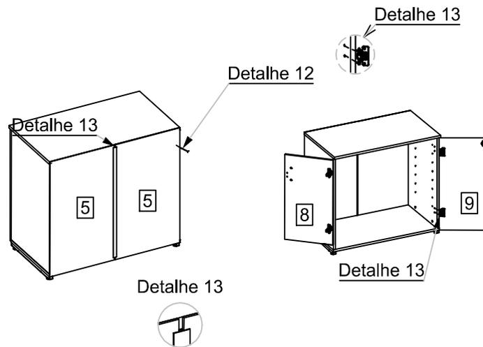
Na sequência fixar o Fundo (5) com a utilização de pregos (H) nas Laterais (1) e (3), Tampo (2) Base (4) e perfil H, conforme (Detalhe 12 e 13).
