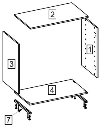
Inicie fixando a Lateral Direita (1) à Base (4), Lateral Esquerda (3) Tampo (2) e Rodapé (7).
