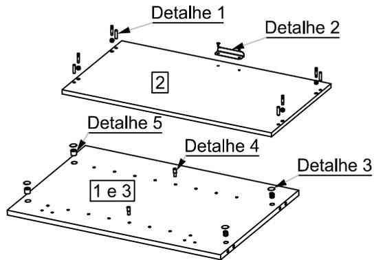
Obs. Os componentes de fixação são iguais nas duas laterais peças (1) e (3).
