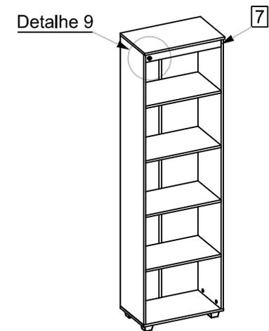
Após a fixação do fundo, fazer colocação do Montante peça (7).
