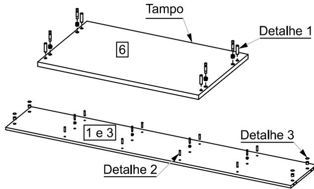
Obs. Os componentes de fixação são iguais nas duas laterais peças (1) e (3).
