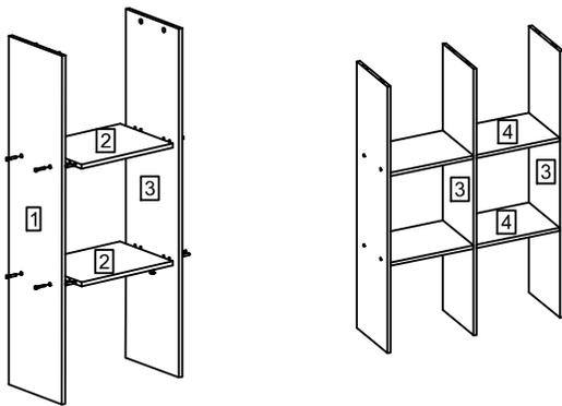
Inicie a montagem da esquerda para a direita fixando a Lateral Esquerda (1), às Prateleiras Fixas (2) e Lateral Interna (3). Obs Utilizar o parafuso estrutural (G) para prender a lateral esquerda à prateleira fixa e Minifix haste dupla (B) para fixar a prateleira fixa à lateral interna.
