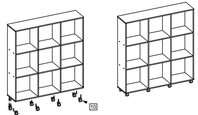
Após a colocação da Base os Rodízios (10) poderão ser fixados (Detalhe 6).
