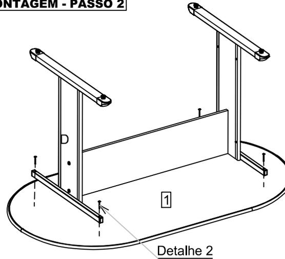
Inicie montando a estrutura: fixe o pé lateral direito (3), ao painel frontal (2) e pé lateral esquerdo (4) como indicam as imagens. Utilizar Parafuso estrutural (A).
