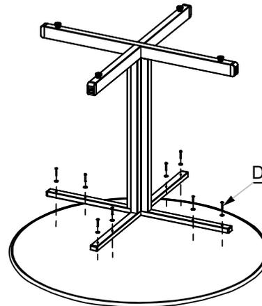
Inicie montando a estrutura: faça o encaixe do Pé inferior (2) no Pé Superior (3) conforme (Detalhe 1).
