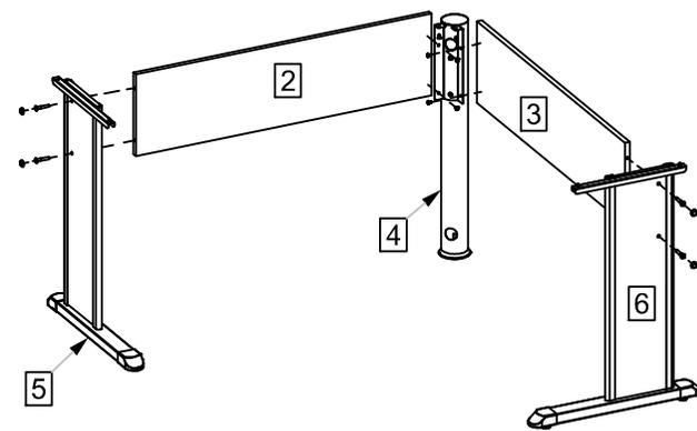
Inicie montando a estrutura: fixe o Pé Lateral Esquerdo (5), Painel Lateral Esquerdo (2), Coluna Pé Canto (4), Painel Lateral Direito (3), e o Pé Lateral Esquerdo (6).
