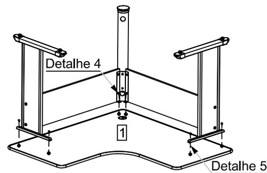
Na sequência para facilitar a fixação do Tampo (1) na estrutura, posicione o Tampo (1) no chão e faça a fixação total dos pés laterais e Coluna Pé Canto (4) com parafusos (C).
