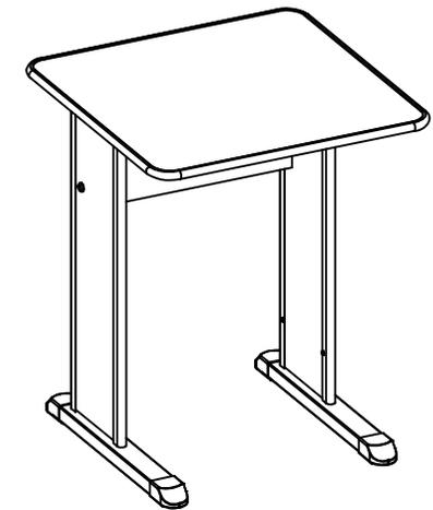
Inicie montando a estrutura: fixe o pé lateral direito (3), ao painel frontal (2) e pé lateral esquerdo (4) como indicam as imagens. Utilizar Parafuso estrutural (A).
